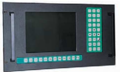
Abb.: Monitor, 19" Frontplatte und Folientastatur
